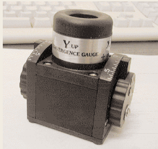
Przyrząd do pomiarów zbieżności składowych barwnych obrazu.
